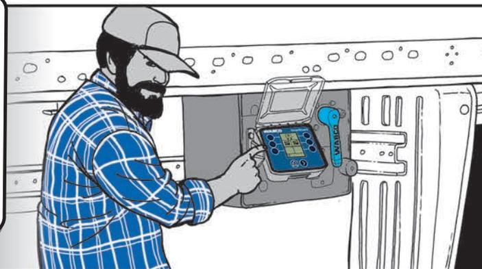
Sur la télécommande ECAS, appuyez simultanément sur les touches M1 et STOP pour enregistrer la hauteur en mémoire.
