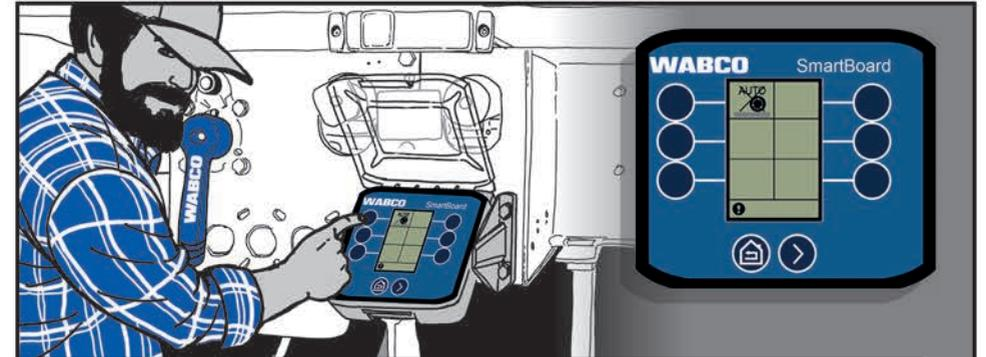
La fonction AUTO pour OptiTurn doit être activée dans le SmartBoard. Si elle ne l'est pas, comme vous le voyez ici, il suffit d'appuyer sur le bouton pour la modifier.
