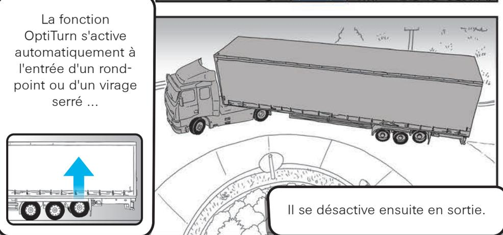
La fonction OptiTurn s'active automatiquement à l'entrée d'un rond-point ou d'un virage serré ...
