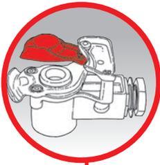
Entscheidend ist eine betätigte Feststellbremse... wichtig ist auch die Verbindungsreihenfolge von roten und gelben Kupplungsköpfen
