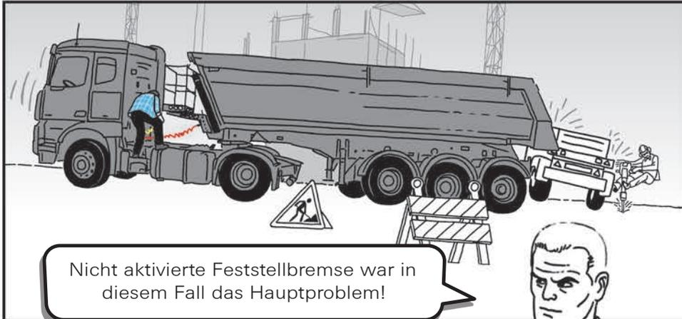
Roter Kupplungskopf - eine permanente Luft-versorgung für den Anhänger. Durch die Entkopplung wird die Notauflegerbremse aktiviert und durch das Ankuppeln wieder deaktiviert.
