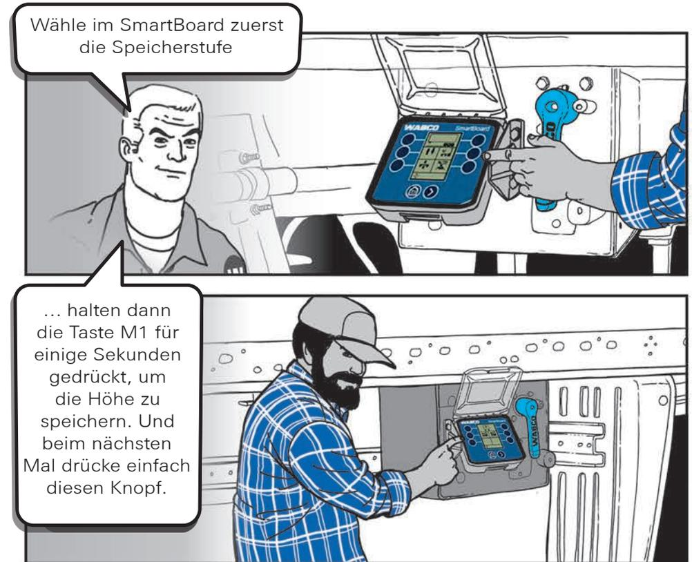
Drücke in der ECAS Steuerung die Tasten M1 und STOP gleichzeitig, um die Höhe im Speicher zu speichern.
