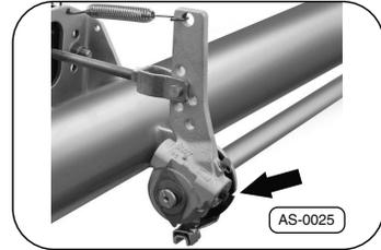
**Fig. 12** · Point de lubrification sur le levier régulateur de frein
