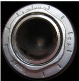
in Fahrtrichtung links - Linksgewinde
