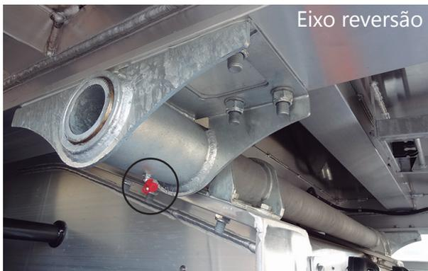
**Cada 3 meses:** Revisar o indicador visual de desgaste de pastilhas. Os travões de disco possuem este indicador na pinça de travão, como indica o manual de manutenção dos eixos. E os travões de tambor possuem este indicador nas alavancas automáticas de travagem.
